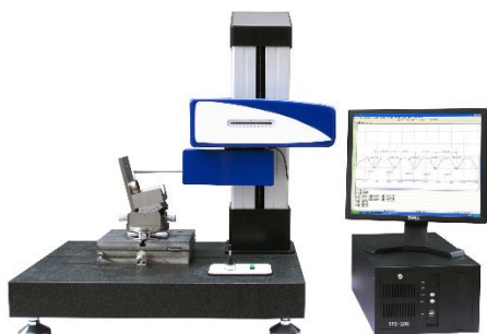
图 1 某种型号的接触式轮廓仪
